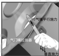
3. 使用气门嘴拉拔器安装传感器总成
